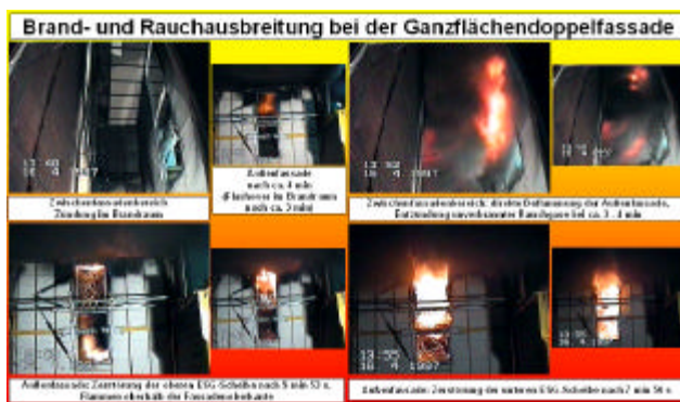
Brandversuch mit Ganzflächendoppelfassade
