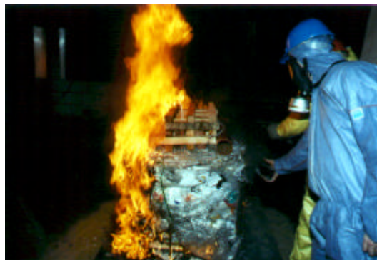
Entnahme einer Brandgasprobe bei einem Brand mit recyclingfähigem Material.
