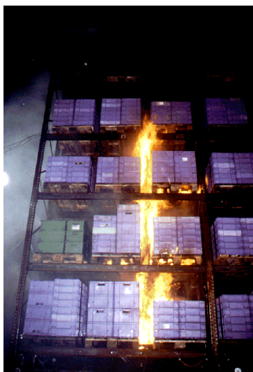
Brand- und Löschversuche an einem Hochregallager mit Niederdruck-Wasserebellöschanlage
